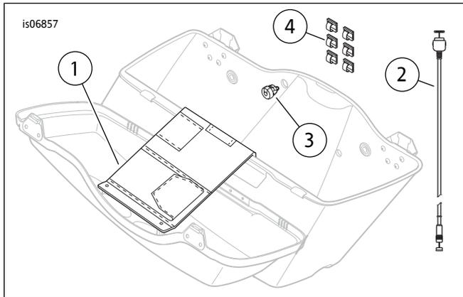
图2。维修零件：边箱iPod安装套件
