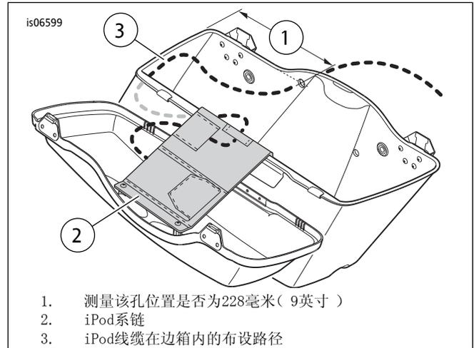
图1. 将iPod底架安装至右侧边箱
