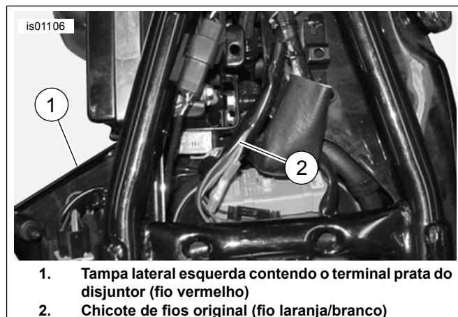
Figura 10. Conexões de energia (modelos XL)
