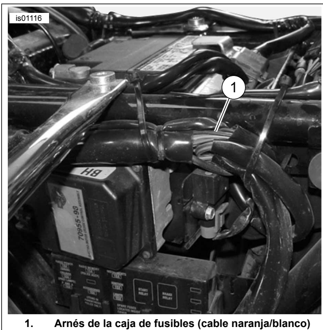
Figura 11. Arnés de la caja de fusibles detrás de la cubierta lateral izquierda, modelos Touring de 2003 o anteriores (se muestra el FLHTCUI)
