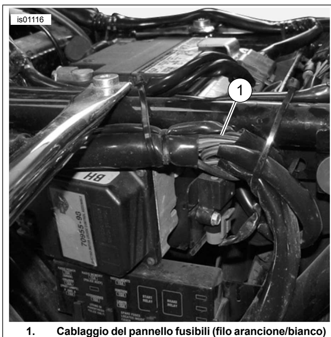
Figura 11. Cablaggio del pannello fusibili dietro il coperchio sinistro, modelli Touring fino al 2003 (è mostrato il modello FLHTCU)
