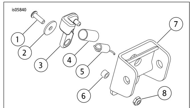
图2。维修零件：枢轴维修套件
