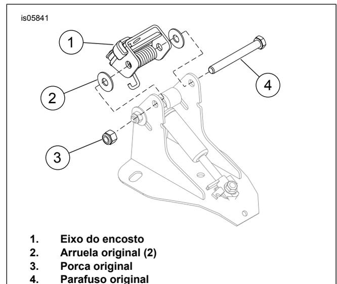
Figura 1. Instalação do eixo do encosto
