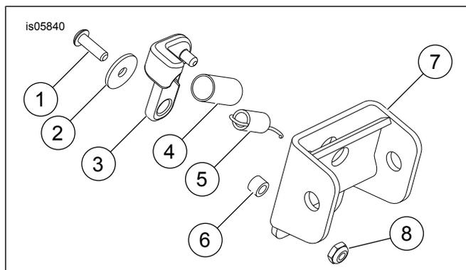
Figura 2. Peças de reposição: Kit de reparo do eixo
