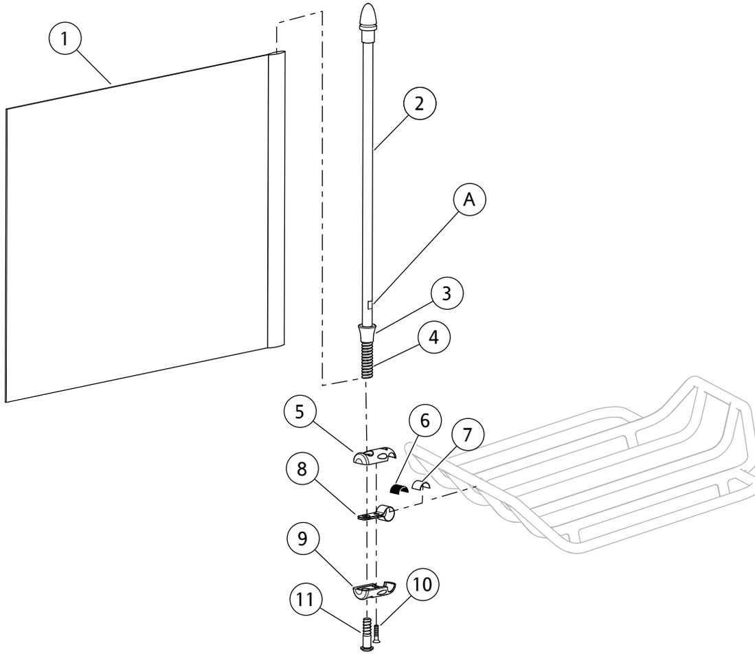
图1。维修零件：高级美国国旗套件
