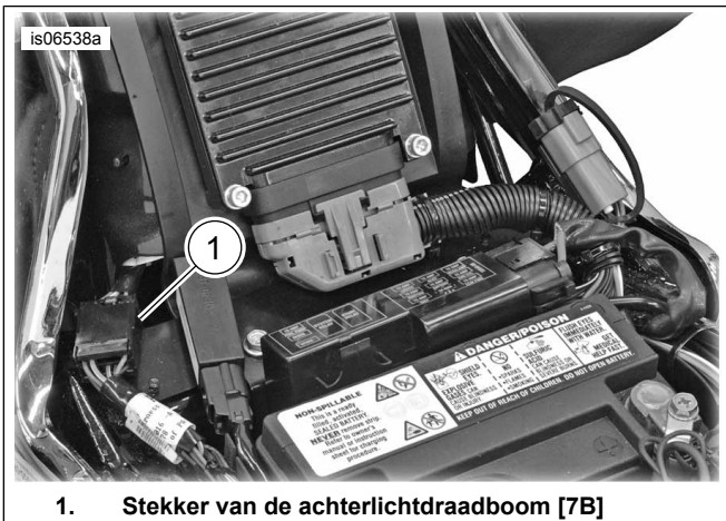
Afbeelding 1. Stekker van de achterlichtdraadboom – Softail-modellen
