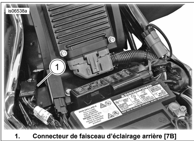
Figure 1. Connecteur de faisceau d'éclairage arrière – modèles Softail
