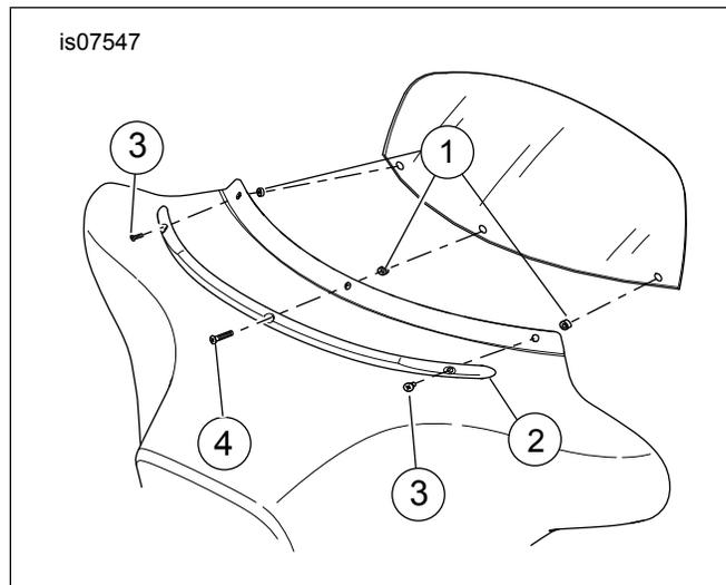
Figura 1. Peças de reposição: Kit de moldura de para-brisa
