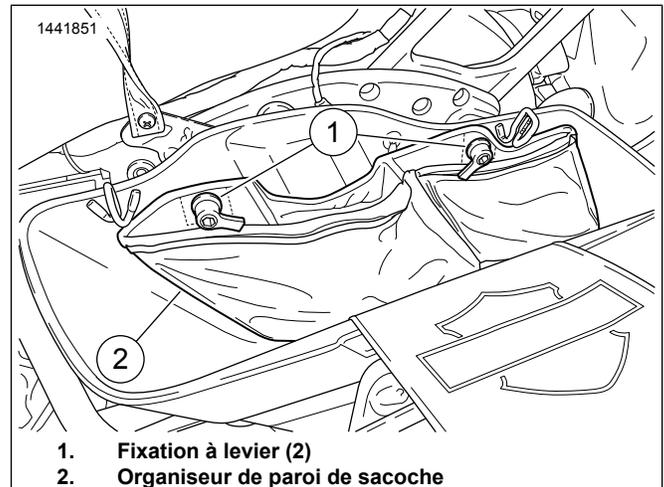
Figure 2. Installer l'organiseur de paroi de sacoche (2017 et modèles ultérieurs)
