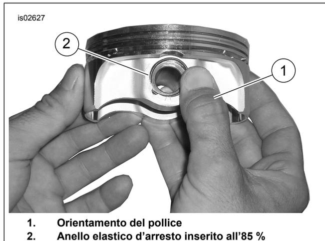
**Figura 4. Installazione dell'anello elastico d'arresto**
