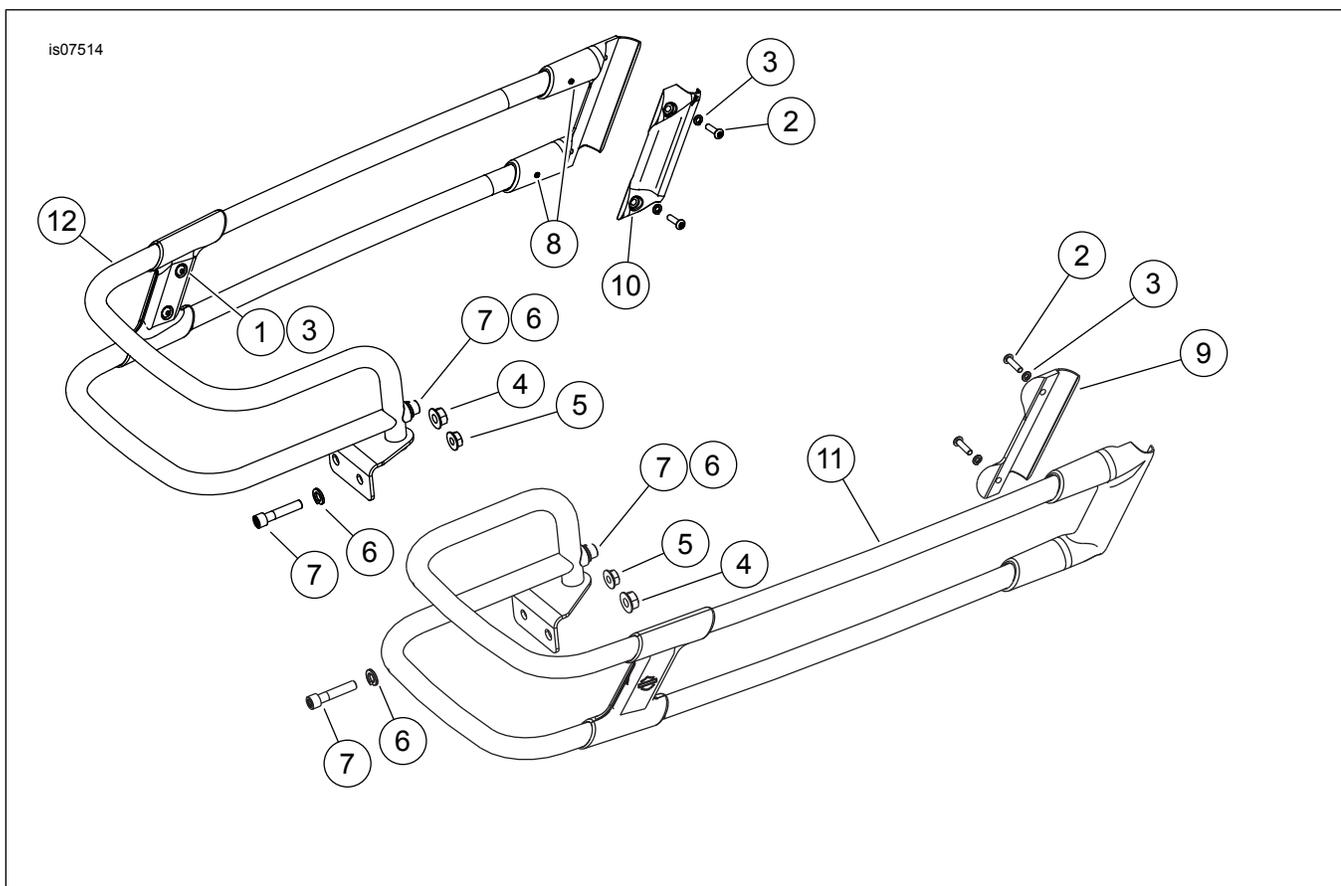
Figure 3. Pièces de rechange : Kit de barres protectrices de sacoche
