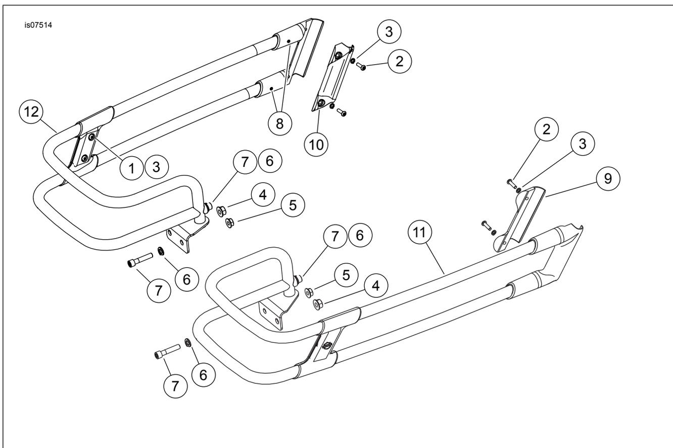
Figura 3. Peças de reposição: Kit de barra de proteção para o alforje
