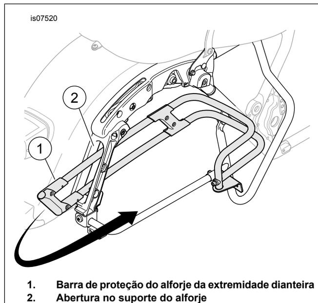
Figura 1. Orientação da instalação
