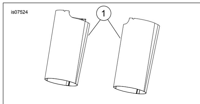
Figura 1. Peças de reposição: Tampas do tubo externo do garfo
