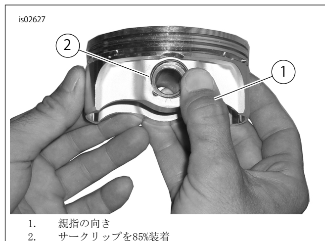
図4。サークリップの取り付け
