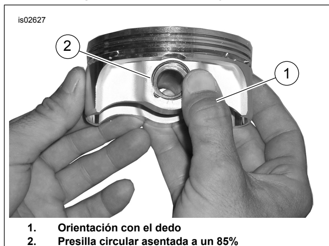
Figura 4. Instalación de la presilla circular
