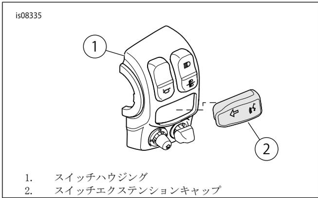
図2。スイッチエクステンションキャップの取り付け(左側を表記)
