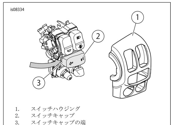
図1. スイッチキャップの取り外し(左側表記)
