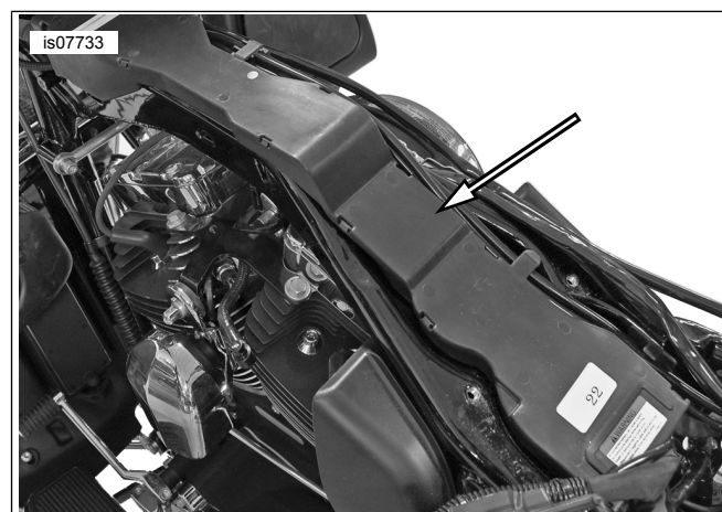
Figura 1. Canal de cables
