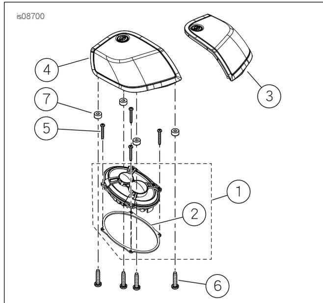
圖3. 維修零件、Boom! AudioStage II側箱揚聲器套件
