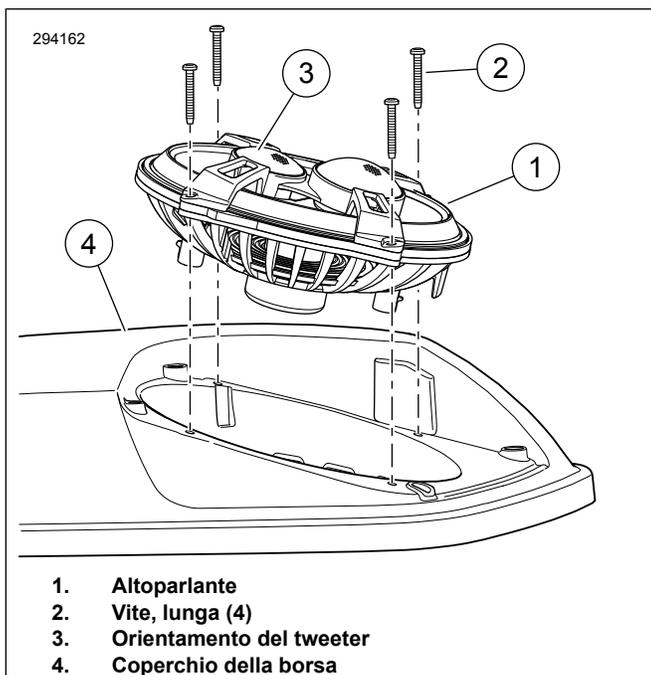
Figura 1. Orientamento dell'altoparlante
