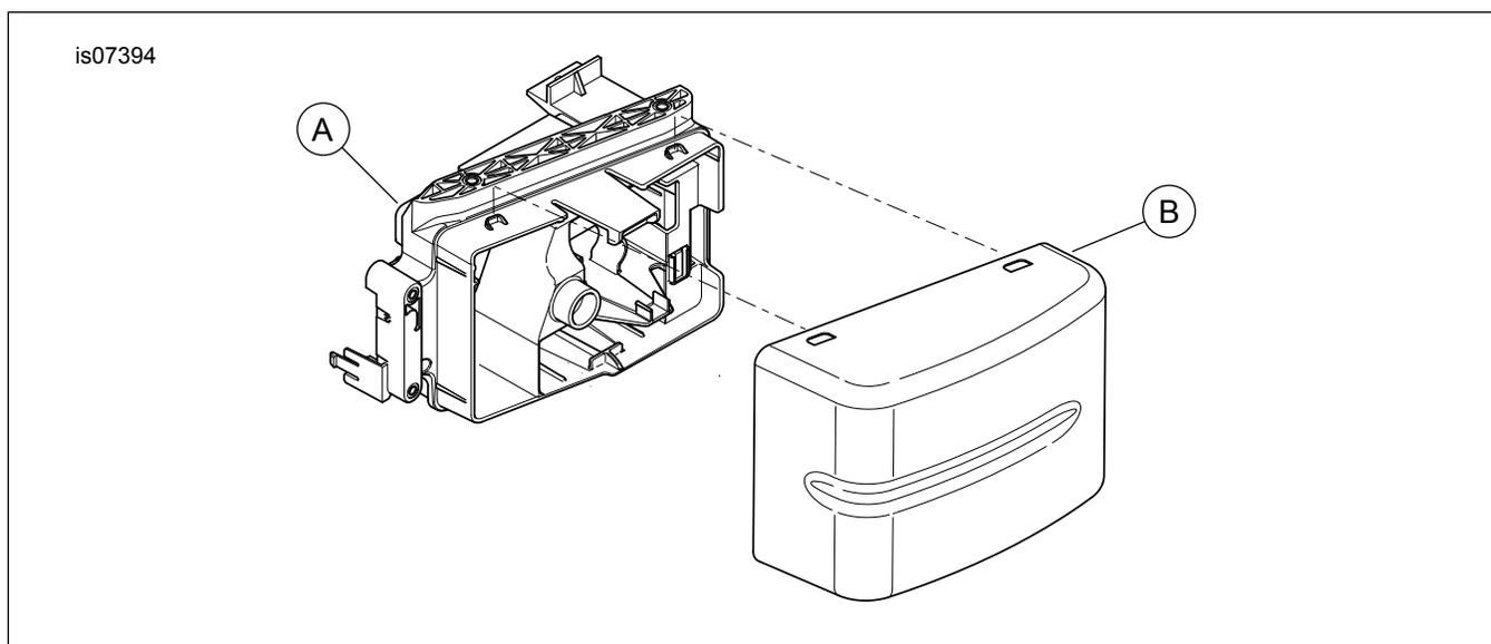
**Figura 4. Peças de reposição: Suporte elétrico e tampa**
