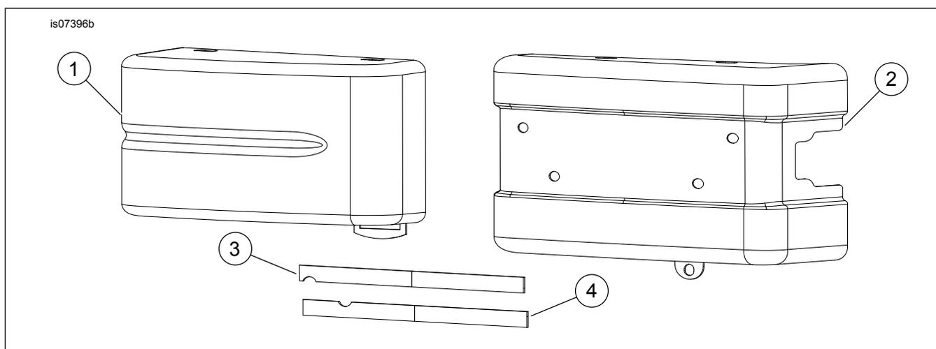
**Figura 5. Suporte elétrico e tampa**
