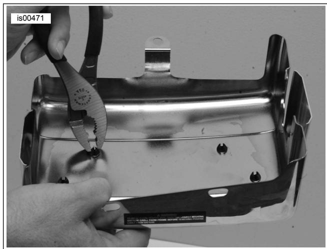
Figura 2. Empurre as linguetas travas para fora da tampa da bateria
