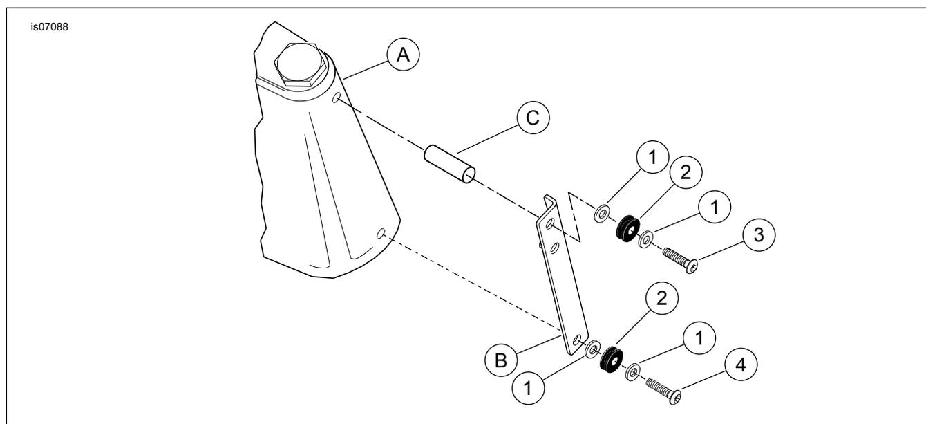
**Figure 2. Pièces détachées : Kit de visserie**
