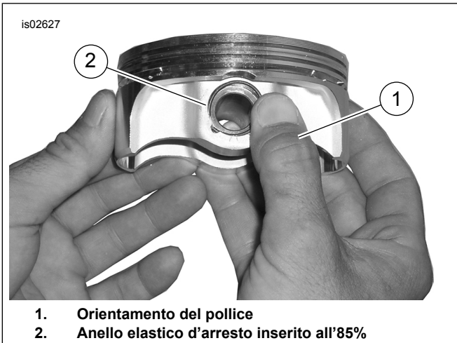
Figura 4. Installazione dell'anello elastico d'arresto
