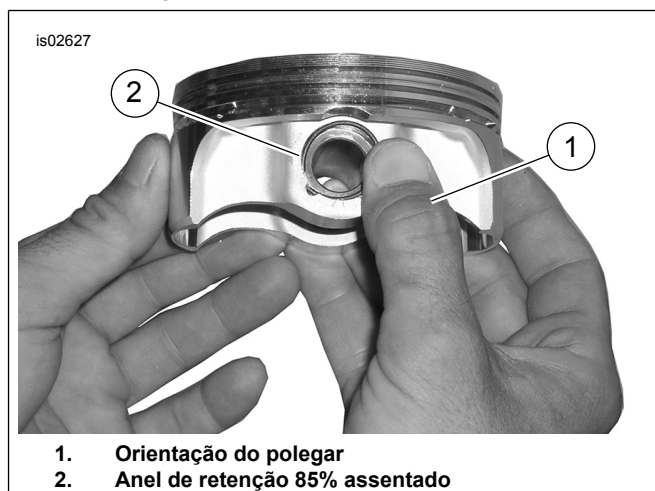
Figura 4. Instalação do anel de retenção
