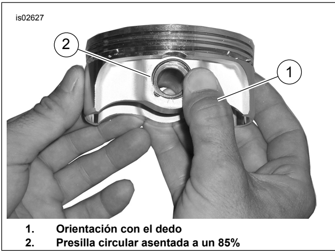
Figura 4. Instalación de la presilla circular
