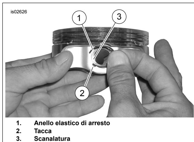
Figura 3. Anello elastico d'arresto e pistone
