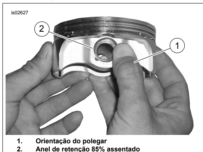
Figura 4. Instalação do anel de retenção
