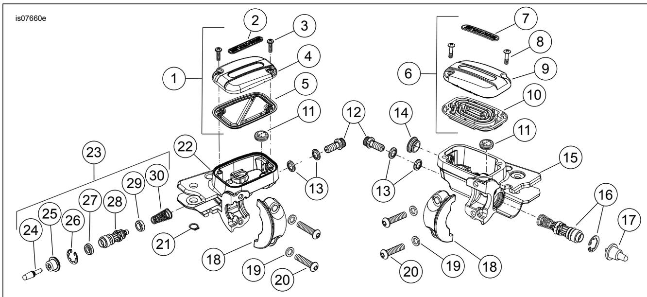
Figura 1. Parti di ricambio: Kit cromato pompa/serbatoio di freno e frizione
