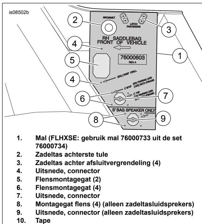
Afbeelding 2. Uitsnede in rechter zadeltas en boringen voor installatie van de Stage II-kabelboom
