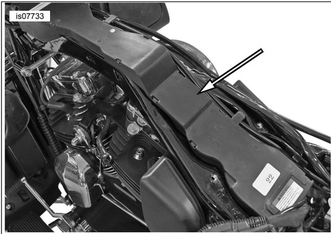
Abbildung 1. Kabelschacht
