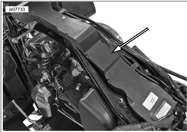
Figura 1. Canal de cables
