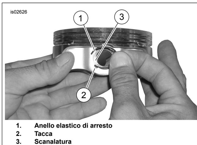
**Figura 3. Anello elastico di arresto e pistone**
