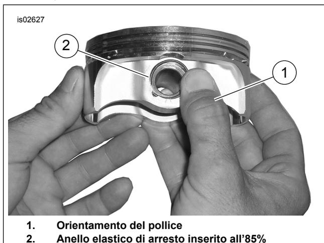
**Figura 4. Installazione dell'anello elastico d'arresto**
