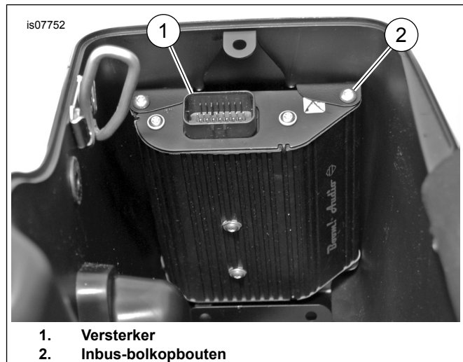
Afbeelding 8. Montage van de versterker
