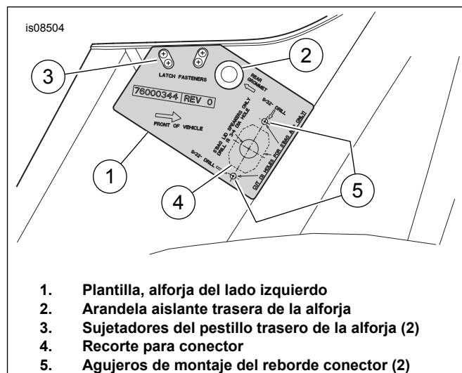
Figura 3. Perforación de la alforja izquierda para la instalación del amplificador Stage II
