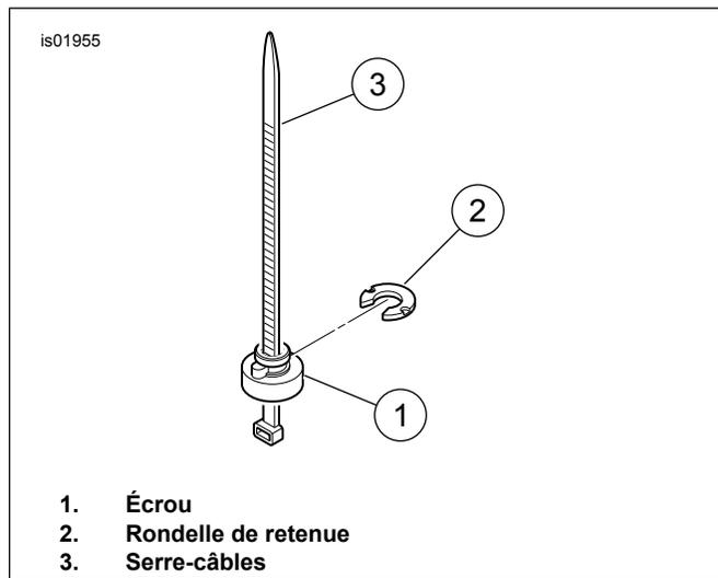
**Figure 3. Écrou de retenue, rondelle et serre-câbles**
