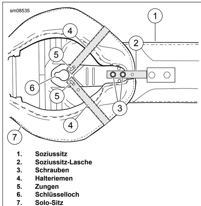
**Abbildung 4. Siehe Einbau des Soziussitzes und des Halteriemens.**
