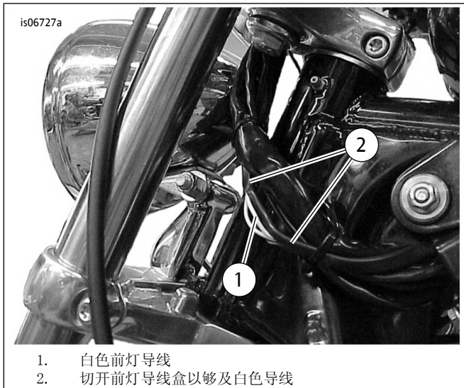
图32。白色导线可选外部拼接位置(运动者车型)
