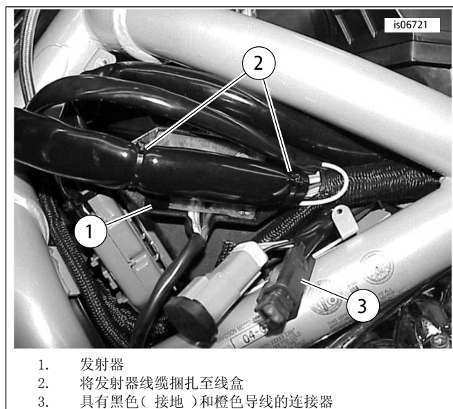
图18。安装发射器（仅2002-2003年款威路德车型）
