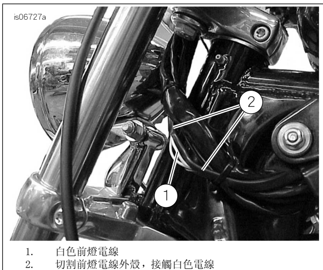
圖32。白色電線可選外部拼接位置( Sportster車型 )
