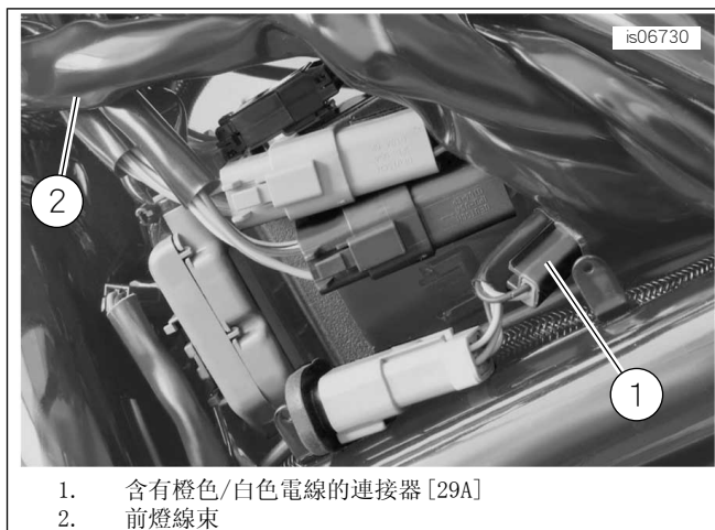
圖29. 電線拼接位置 ( 2004 年款 V-Rod )
