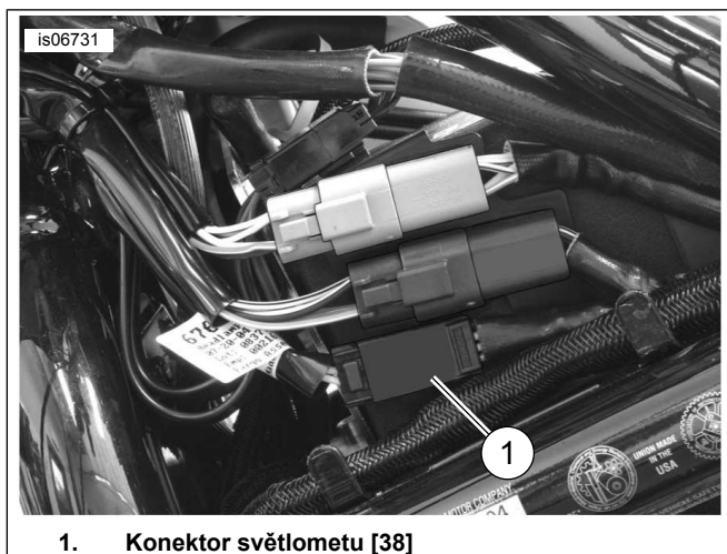
1. Konektor světlometu [38] Ilustrace 30. Místa spojení kabelů (modely V-Rod z roku 2005 a novější)
