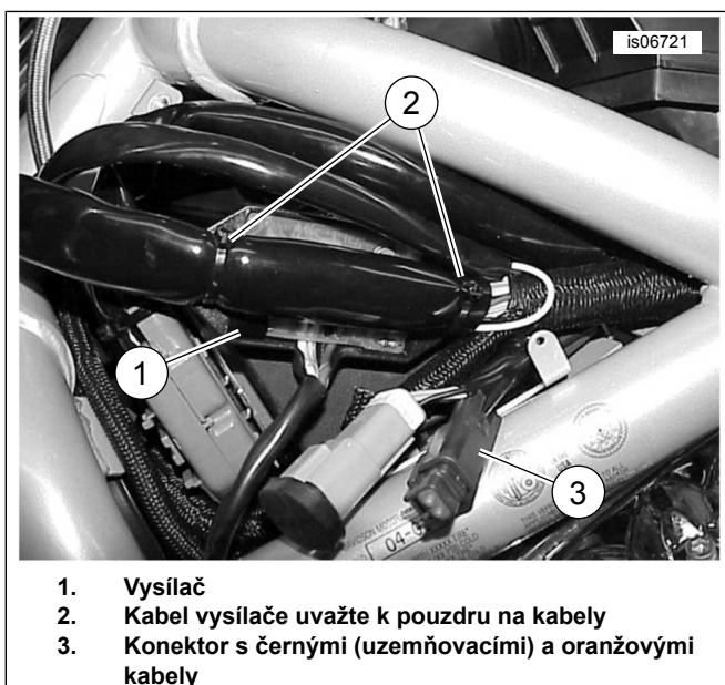
Ilustrace 18. Upevnění vysílače (pouze modely V-Rod z let 2002–2003)
