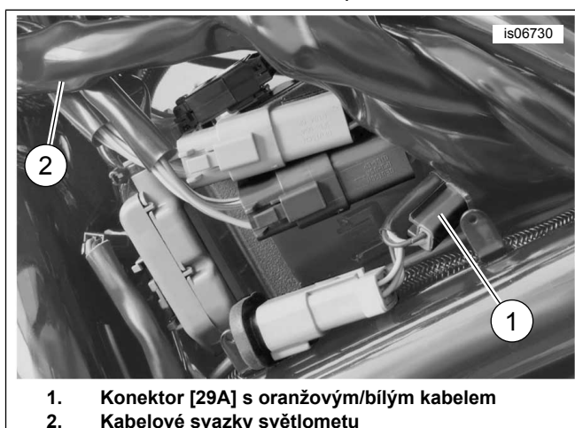
Ilustrace 29. Místa spojení kabelů (modely V-Rod z roku 2004)
