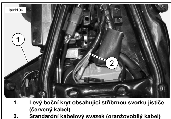
Ilustrace 27. Připojení elektřiny (modely Sportster)
