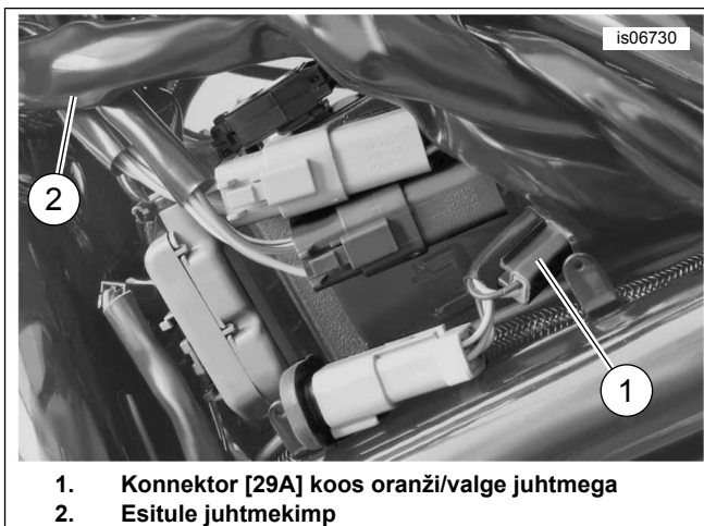
Joonis 29. Juhtmete jätkukohad (2004. a V-Rod)
