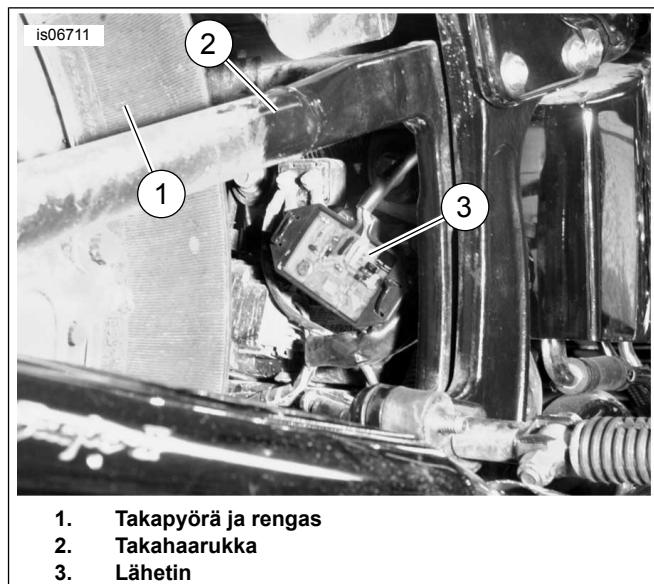
Kuva 5. Lähettimen asennus, vuosien 2000-2017 Softail-mallit paitsi Deuce (kuvassa FLSTC)
