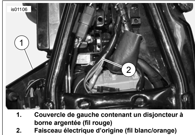
Figure 27. Connexions d'alimentation (modèles Sportster)
