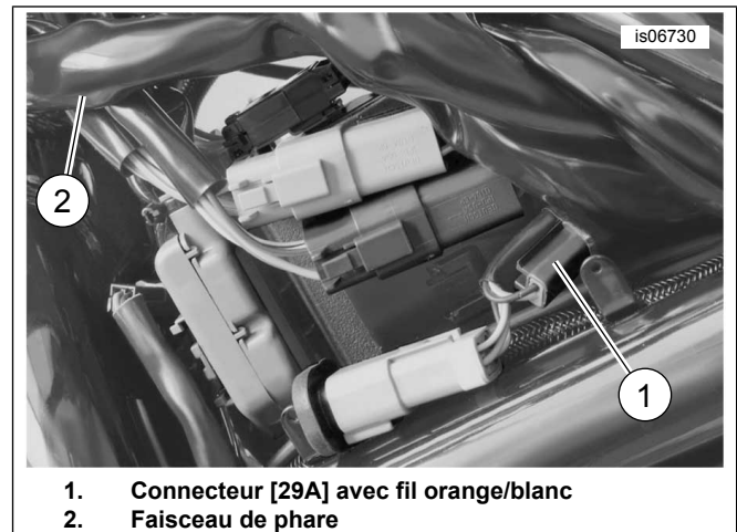
Figure 29. Emplacements d'épissure de fil (V-Rod 2004)
