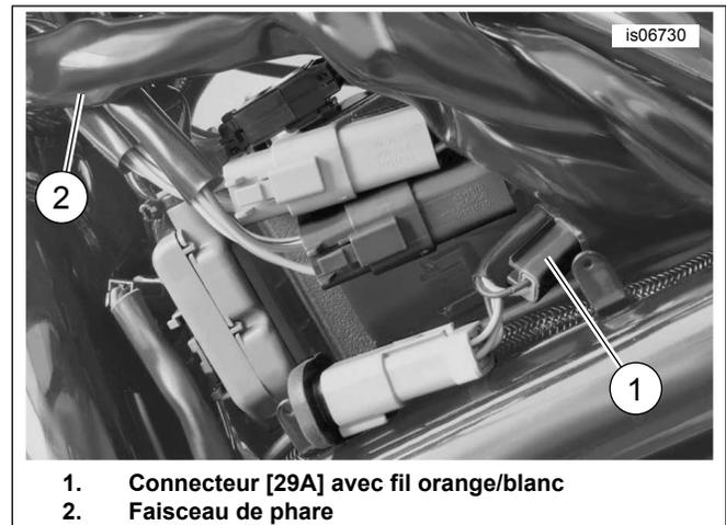
Figure 29. Emplacements des épissures de fil (modèles V-Rod de 2004)
