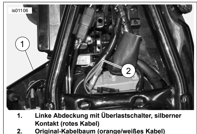
Abbildung 27. Stromanschlüsse (Sportster-Modelle)
