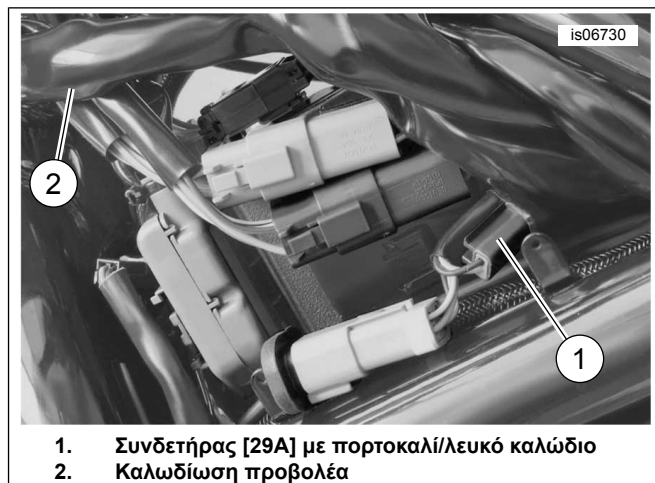
Εικόνα 29. Τοποθεσίες συναρμογών καλωδίων (V-Rod του έτους 2004)
