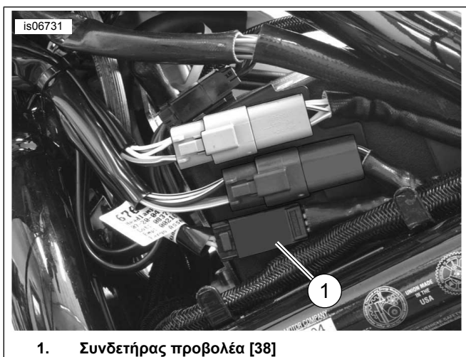
Εικόνα 30. Τοποθεσίες συναρμογών καλωδίων (V-Rod του έτους 2005 και μεταγενέστερα)
