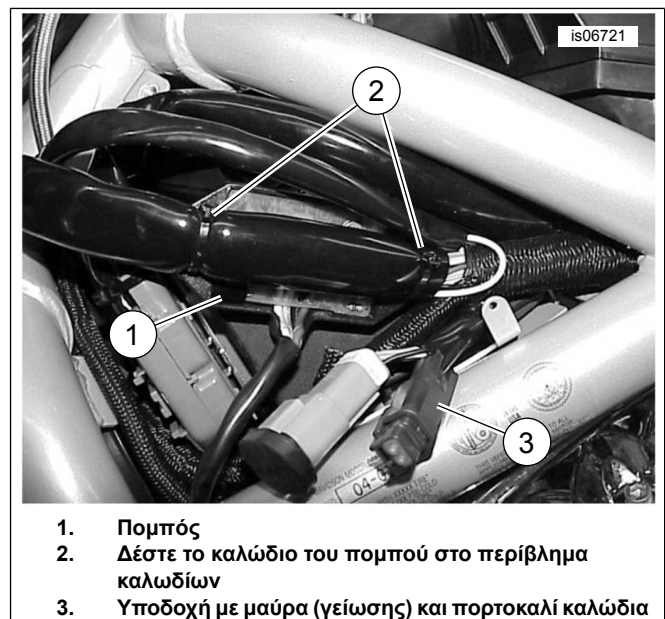
Εικόνα 18. Τοποθέτηση πομπού (Μόνο μοντέλα V-Rod των ετών 2002-2003)
