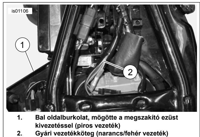
Ábra 27. Tápcsatlakoztatások (Sportster modellek)
