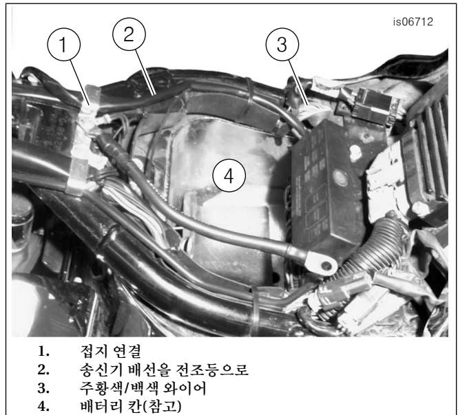
그림 6. 전원 및 접지 연결, 2000-2017 Softail(FLSTC 표시)
