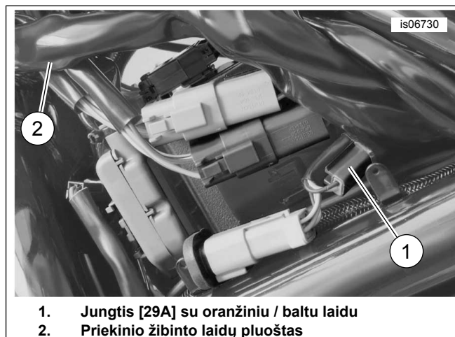
Pav 29. Laidų sudūrimo vietos (2004 m. „V-Rod“)
