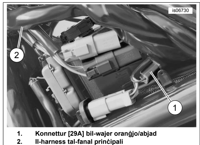
Figura 29. Il-Postijiet tal-Isplice tal-Wajer (V-Rod tal-2004)
